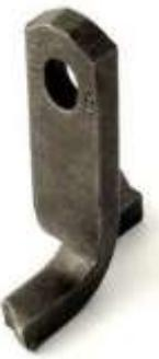
◎Este anclaje es una alternativa al anclaje de placa. Se utiliza principalmente en elementos con una resistencia del hormigón al levantamiento superior a 25N/mm<sup>2</sup>. Por ejemplo, paneles de desmoldeo, elevación de losas finas, tuberías de hormigón.
