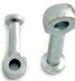
◎ Los anclajes de ojo se utilizan principalmente para levantar las unidades prefabricadas de hormigón delgadas, como paneles, vigas y viguetas, donde la delgadez del hormigón requiere acero de refuerzo adicional, para ser conectado al anclaje para obtener la capacidad de elevación requerida.
